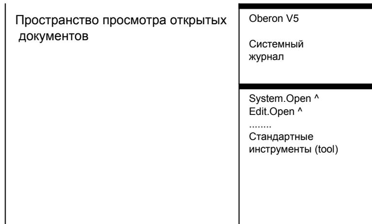
Справа находится системный трек с двумя окнами просмотра (вьюверами). Верхнее отображает журнал (Oberon.Log), в котором система описывает свое поведение и действия пользователя. Нижнее окно - это окно стандартных инструментов, содержащее различные общие команды (Мы называем «инструменты» - тексты содержащие список команд для определенной цели).
