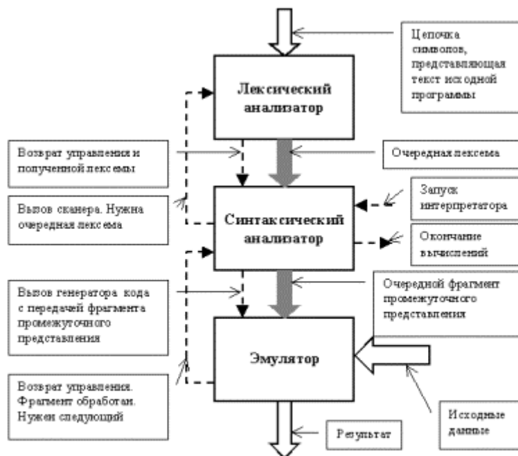
Рис. 1.10. Однопроходное взаимодействие блоков интерпретатора.
