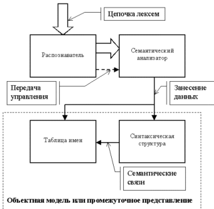
Рис. 1.6. Обобщенная схема синтаксического анализатора
