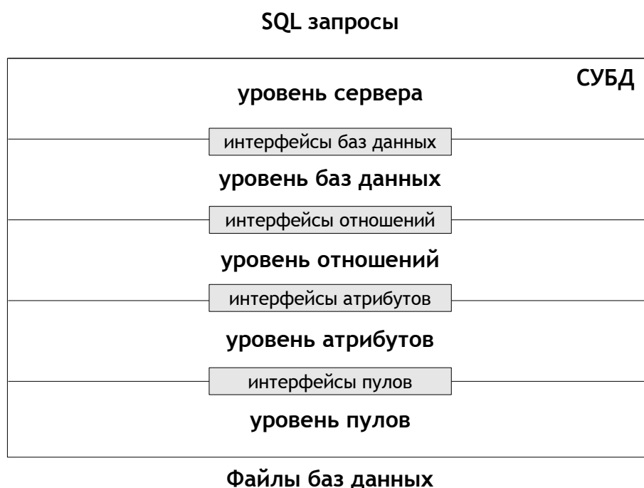
Рис. 6. Уточненная архитектура СУБД
