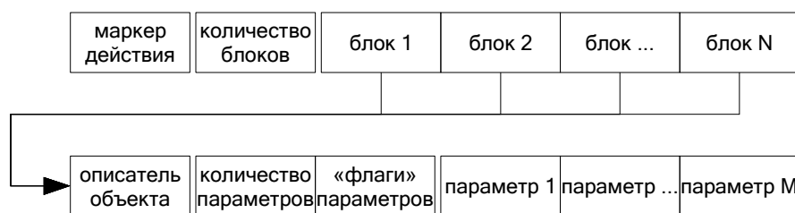
Рис. 12. Структура элементарного действия в запросе
