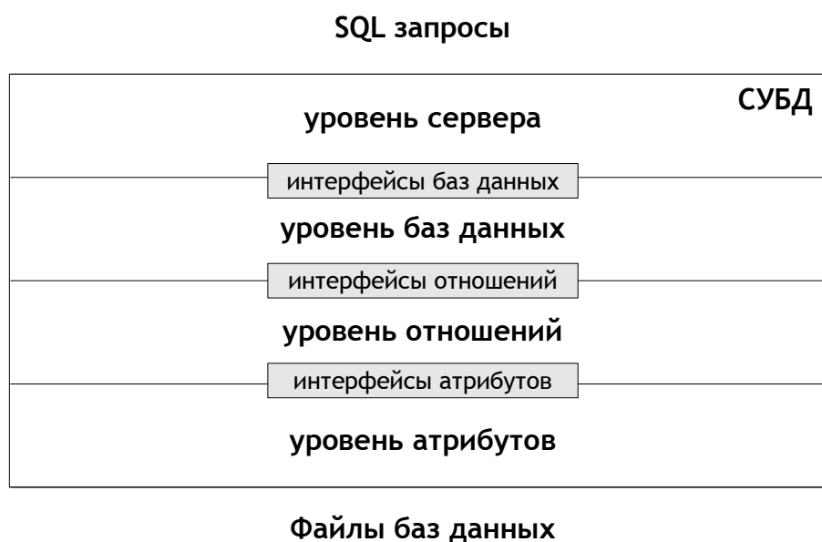
Рис. 2. Архитектура системы управления базами данных
